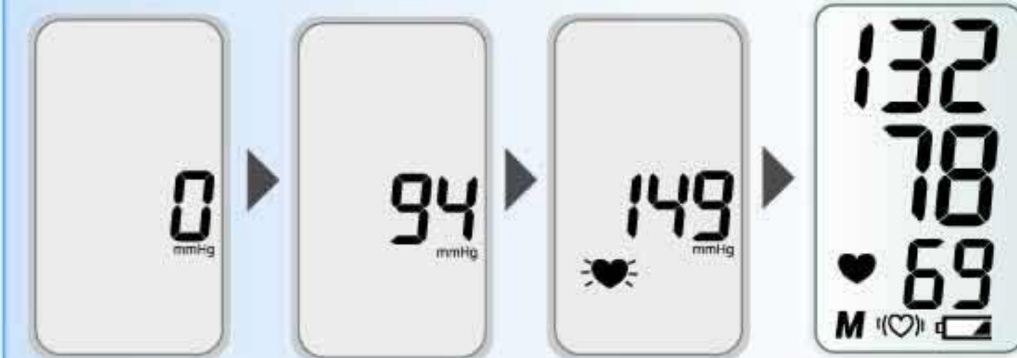
(图1-图3) 腕带自动充气与测量过程
